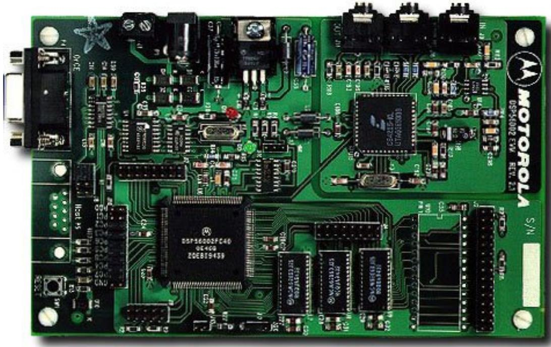
Fig. 13. The Motorola DSP56002 Evaluation Module
