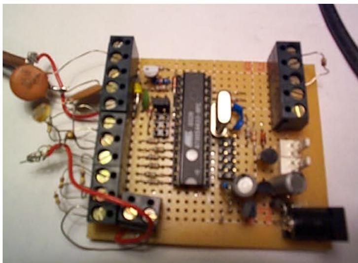
Fig. 27. The ZL1BPU Hell Keyer (used an AT90S4433 processor)
