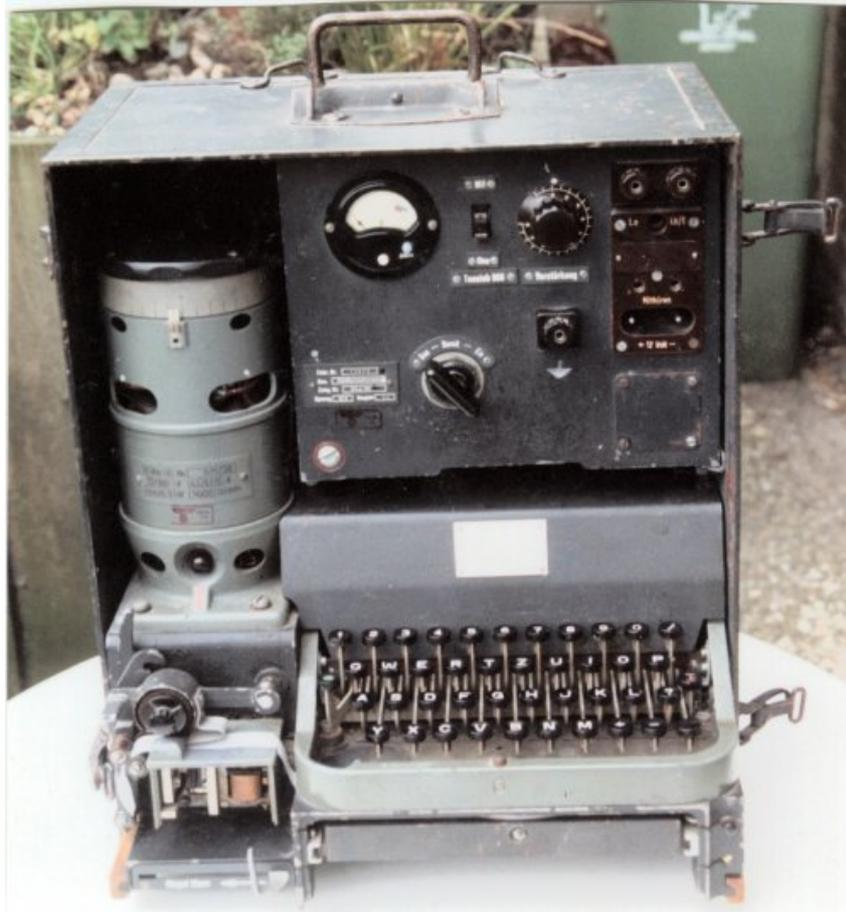
Fig. 23. Wartime Siemens A2 Hellschreiber machine (Dick Rollema PA0SE)
